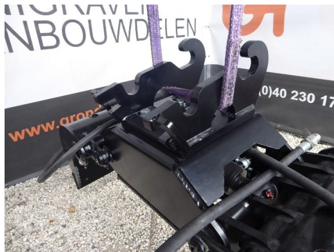
Afbeelding 5 Het transporteren van de sorteergrijper met een hijsband.
