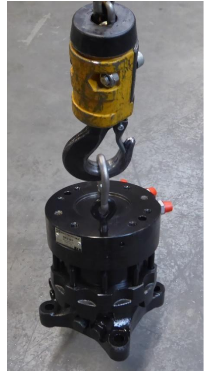
Afbeelding 15 Hijsen van de losse rotator met hijs oog.
