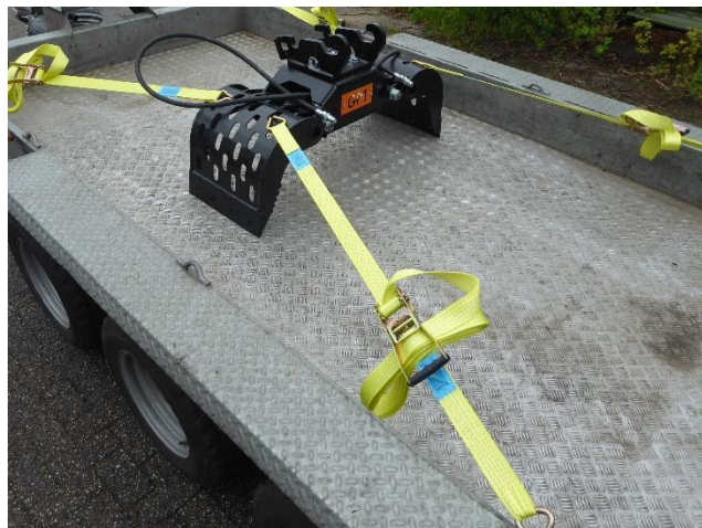
Afbeelding 6 Het vastzetten van de sorteergrijper voor transport over de weg.
