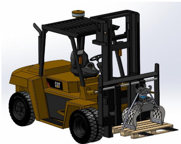
Afbeelding 4 Het transporteren van de sorteergrijper met een heftruck.
